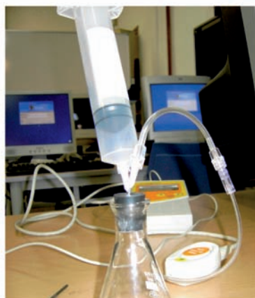
Figura 3. Muntatge per mesurar la pressió de vapor. A la dreta, el gràfic obtingut en una determinació de la pressió de vapor de l'acetona.
