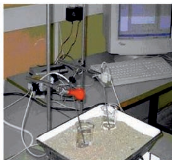
Figura 2. Vaso amb acetona i etanol escalfant-se en un bany de sorra construït amb materials casolans, amb els sensors de temperatura a l'interior. A la dreta, s'hi poden veure els resultats obtinguts de l'experiència
